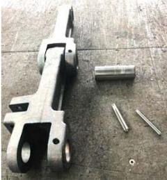
2. Die vormontierten Stränge sind mittels der mitgelieferten Einzelkomponenten zu verbinden. Die jeweiligen Einzelteile sind einem Strang zugeordnet und daran befestigt.
