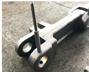
4. Bei Doppelstrangkettensystemen sind beide Seiten parallel zu montieren. Die Kratzeisen werden gemäß unserer Auftragsbestätigung vormontiert oder der Lieferung zur Montage vor Ort beigelegt.
